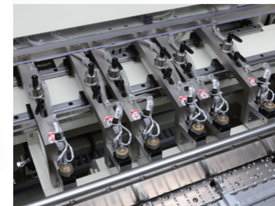
リニアレール採用 Adopt a linear rail
